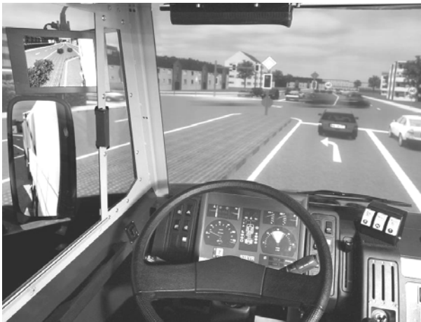
Flexible Fahrzeugnachbildung durch einen Monitor als Instrumententafel
