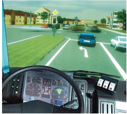
Flexible Fahrzeugnachbildung durch einen Monitor als Instrumententafel
