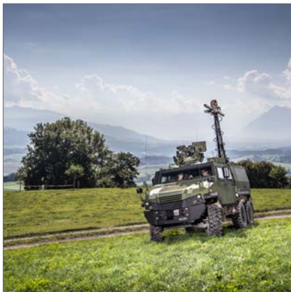
Véhicule porteur avec mât télescopique équipé d'un système multicapteurs
