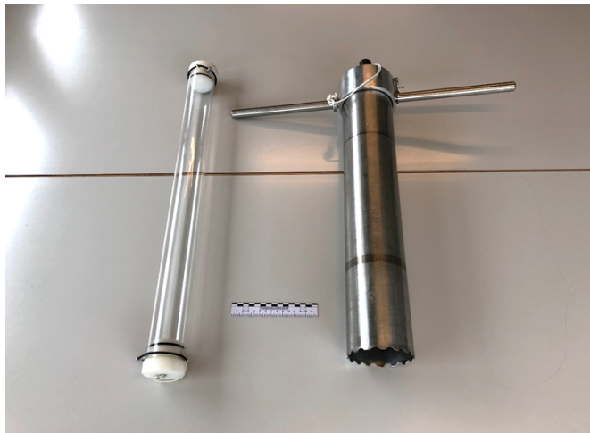
Abbildung 5: Entnahmegeräte für das Stechen der Sedimentproben
