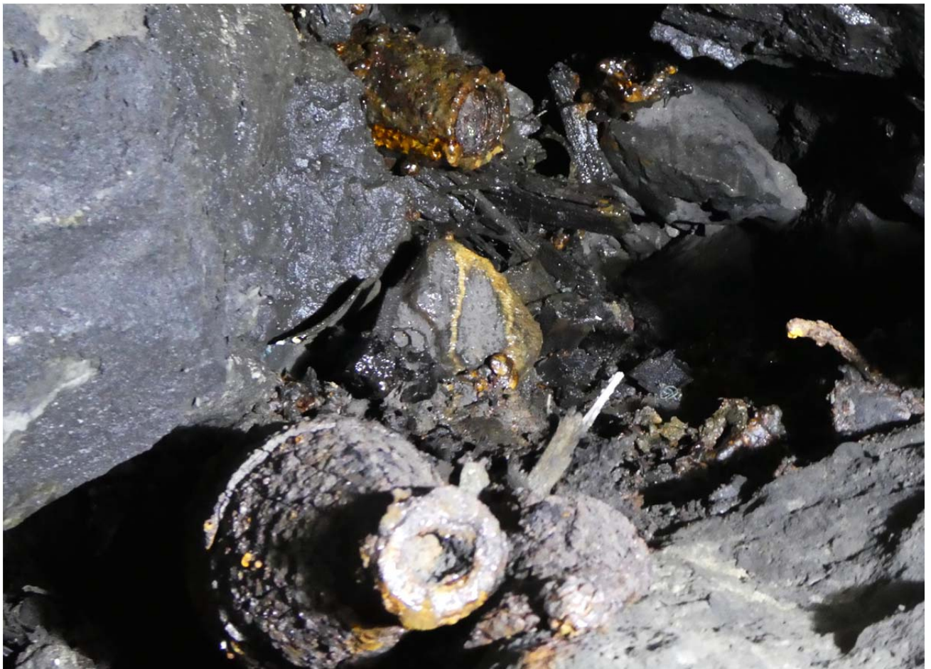
Abbildung 7: Beispiele von korrodiertem Munition
