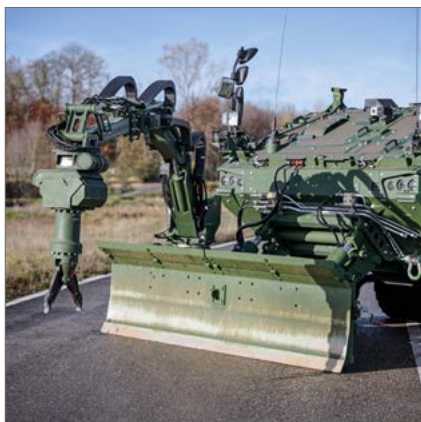
Piranha IV avec lame d'évacuation et bras de préhension
