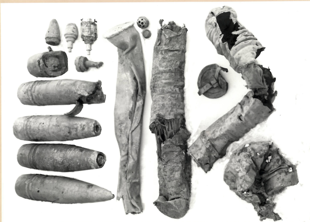
10,5 cm Munition. Zünder - Geschosse - Patronenhülse Blechbüchse mit Pulverladung - Büchse, Inhalt abgebrannt
