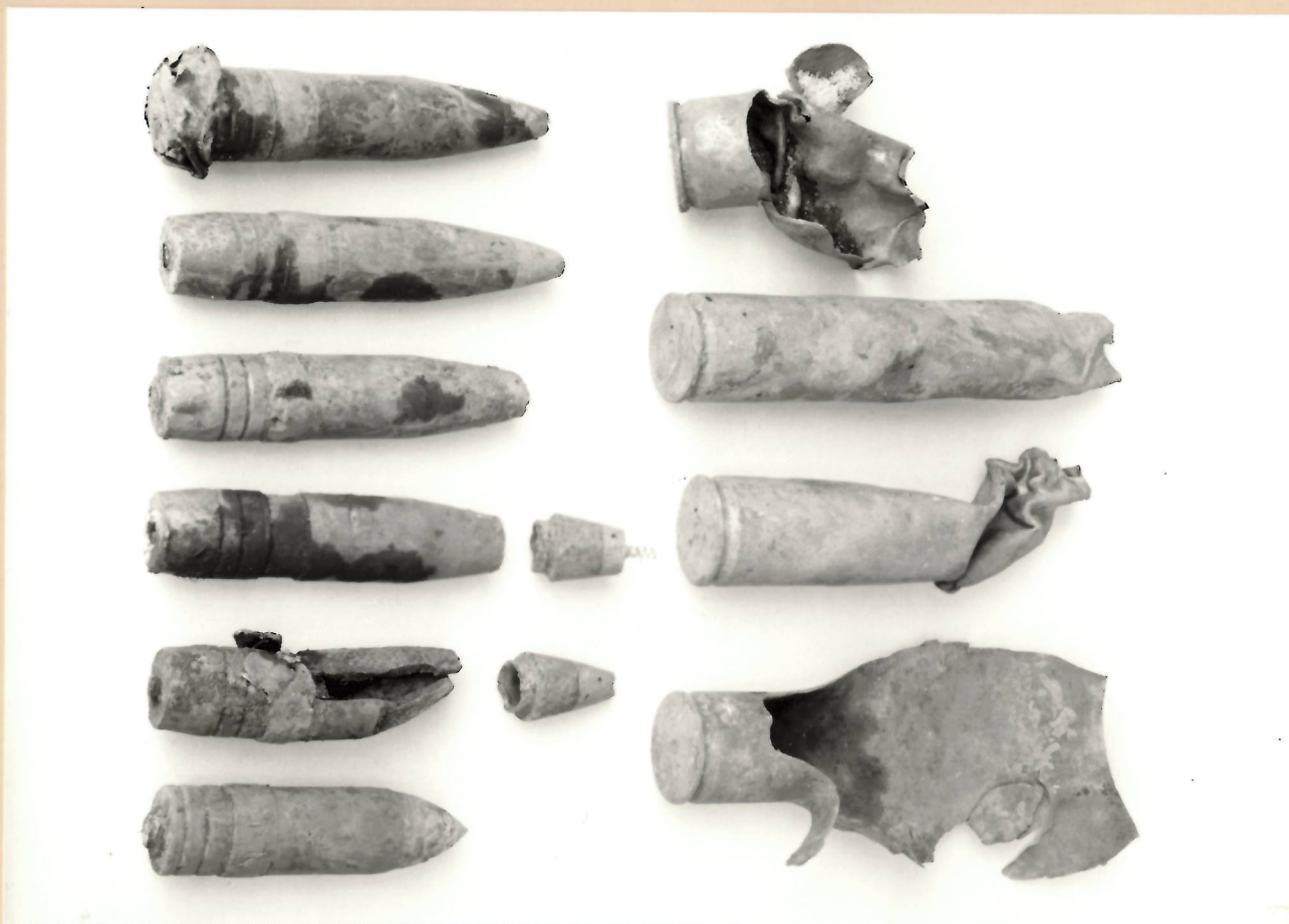
34 mm Flak-Munition - Geschosse, eines davon durch Deflagration geöffnet. Zwei Zünder - Patronenhülsen, zwei noch Treibpulver enthaltend.
