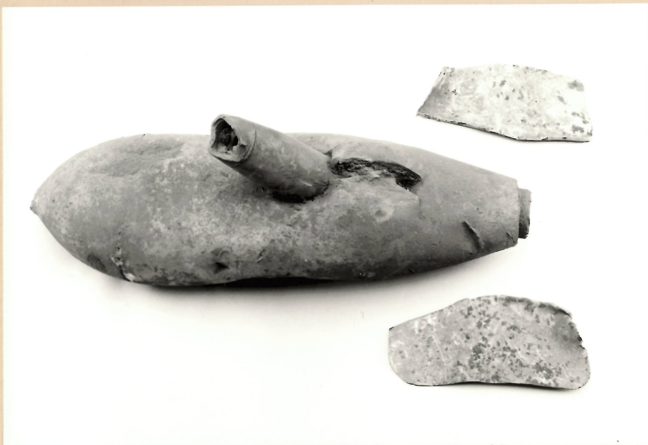
50 kg Flieger-Bombe mit eingedrungenem 7,5 cm Flab-Geschoss - Flügelbleche
