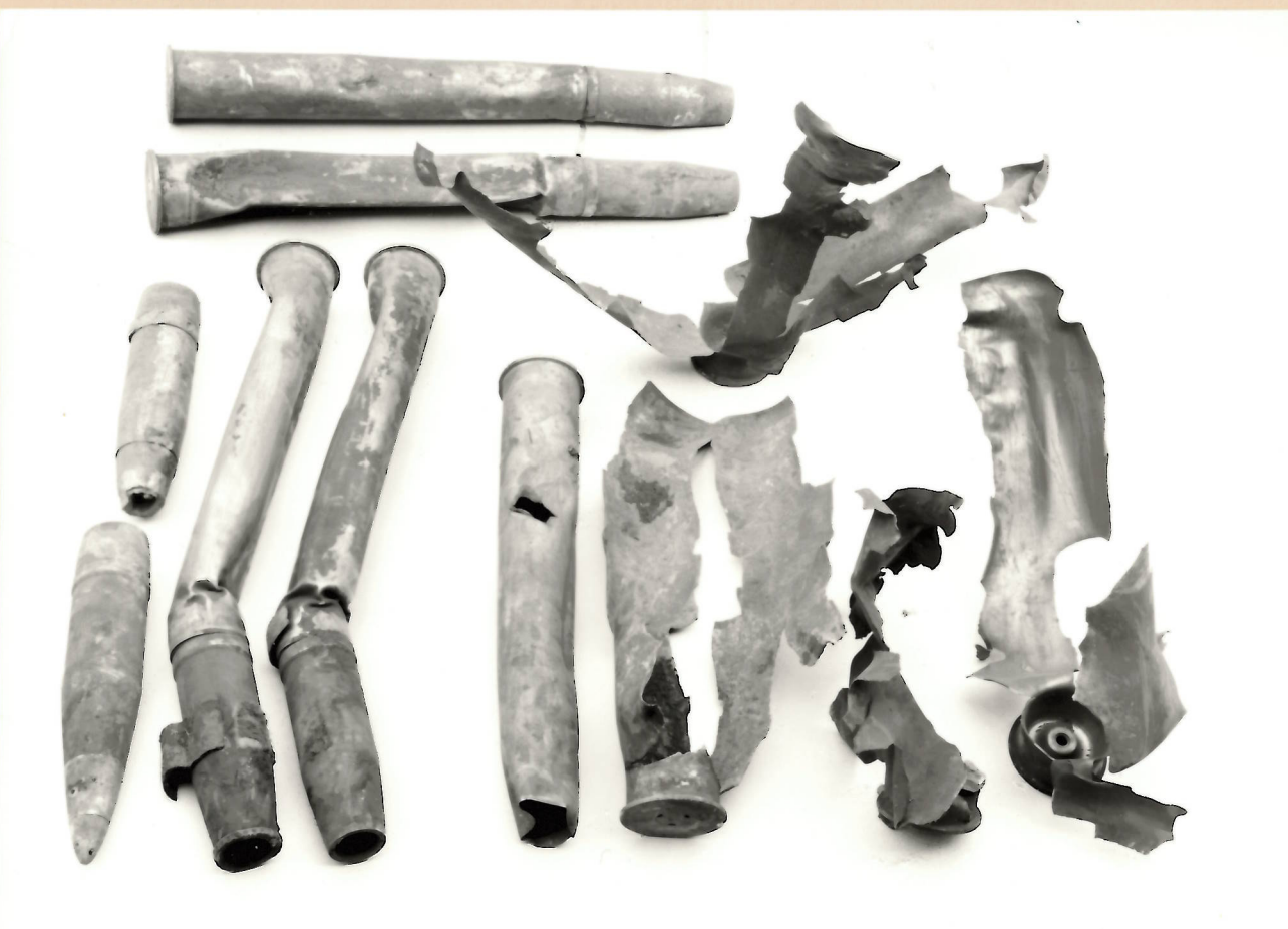
7,5 cm Flak-Munition - Geschosse - Patronen noch Schussladung enthaltend. Hülsen durch Deflagration zerrissen.
