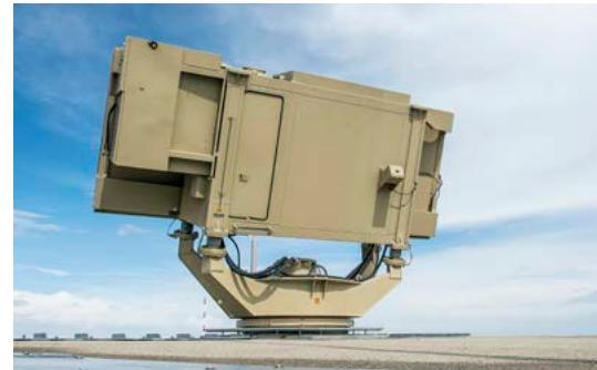
Il sistema di sorveglianza dello spazio aereo e di condotta degli impieghi Florako serve a rilevare gli aerei civili e militari, gli elicotteri, ecc. nonché a gestire gli impieghi delle Forze aeree. L'immagine della situazione aerea generata dai radar di Florako viene completata dai sensori degli aerei da combattimento e della difesa terra-aria.
